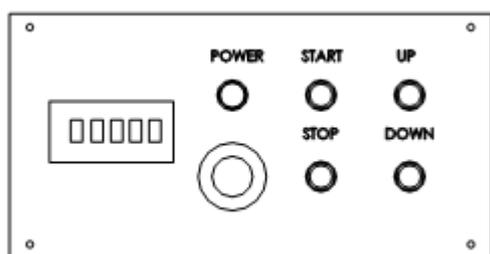
1) Перевести поворотный выключатель ⑦ из положения 0 в положение I для подачи питания на станок, при этом загорится индикатор POWER на панели управления ⑧. Для запуска гидравлической станции нажать кнопку START. Для останова гидравлической станции нажать кнопку STOP или кнопку аварийного останова.
